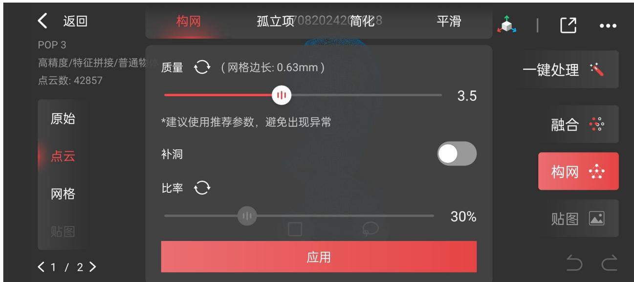
点云融合后，您得到的是一个点云模型。如需网格模型（可用于 3D 打印），可继续对点云模型构网。构网是将离散的点云数据连接形成多个三角形面片，继而生成连续网格的过程。
